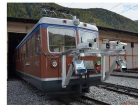
Der Aufbau lässt sich nach den Kundenbedürfnissen konfigurieren und kann flexibel auf einem Trägerfahrzeug montiert werden. Die Datenaufnahme erfolgt mit bis zu 80km/h. Somit wird der Regelverkehr nicht gestört und es muss keine Streckensperrung erfolgen. Wir garantieren einen maximalen Nutzen mit einer minimalen Störung.
