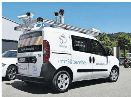
Die Aufzeichnungsfahrzeuge der iNovitas AG fuhren am 24. März durch Schlieren, um das Strassennetz zu erfassen. Bild: zvg
