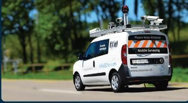
Erfassung der Straßenräume mit infra3D-Technologie und Generierung des intelligenten digitalen 3D-Abbildes der Straßen als perfekte Grundlage für die bildbasierte Analyse.
